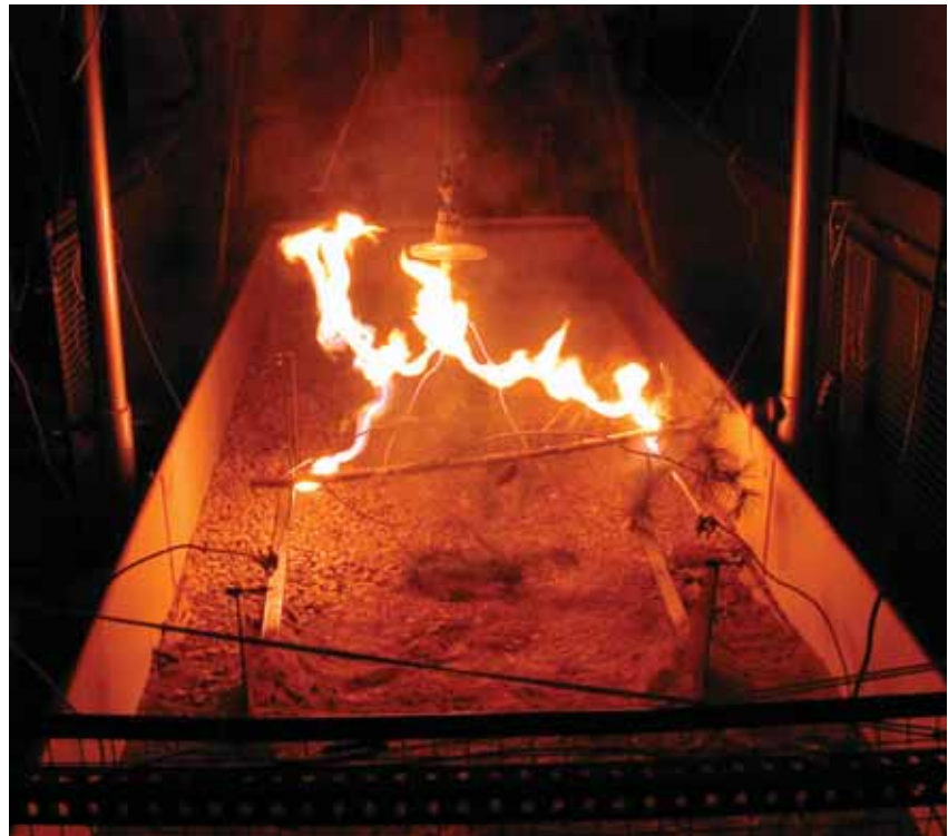
Ensayo de contacto conductor eléctrico -vegetación.
