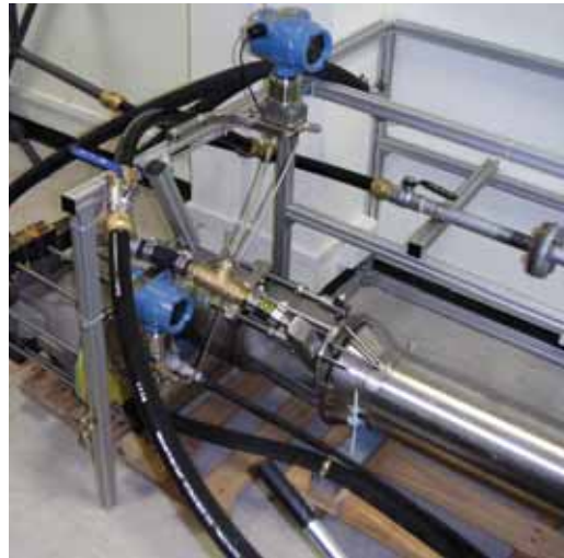
Disposición del caudalímetro de placa y su sensor de presión diferencial DP (1).
